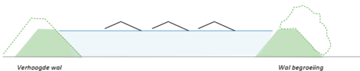
Principedoorsnede inpassing op waterbassins bij te lage omwalling
