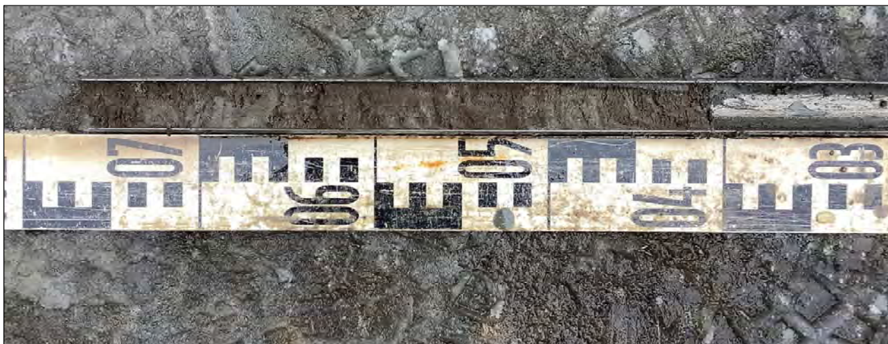
Figuur 22 Boorkern met vermoedelijke afzettingen van de Kreekrak Formatie in boring 1 (440-475 cm -mv).
